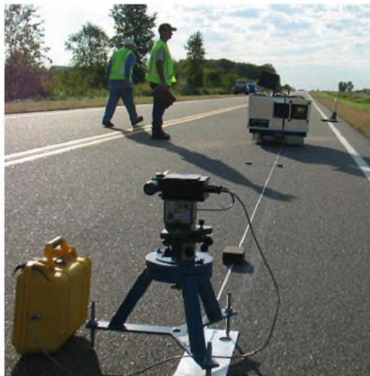
Figure 2.10. Benchmark profiler (Winkler et al., 2013).
