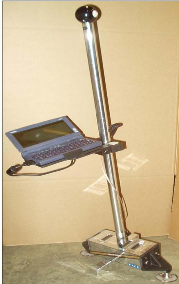
**Figure 16. Dipstick<sup>®</sup> Road Profilometer**
