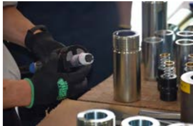
(d) Sliding steel wedge system into CFCC
