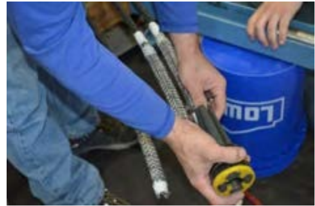
(d) Installing steel wedge system
