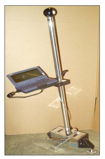
Figure 16. Dipstick<sup>®</sup> Road Profilometer
